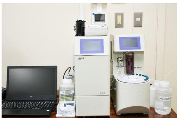
写真3 総酸・アミノ酸測定装置
