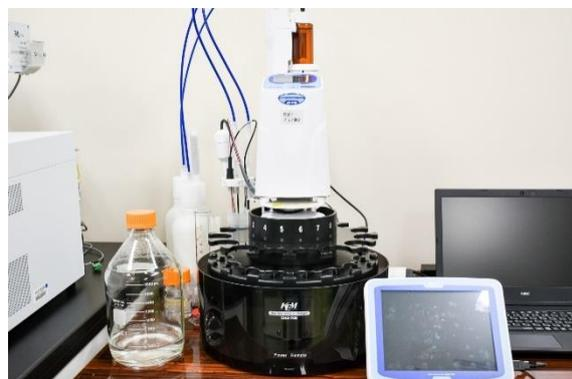
写真4 ピルビン酸・グルコース測定装置
